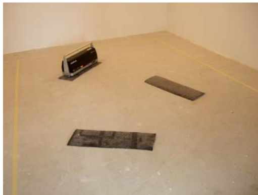
Fotografías 3 y 4. Colocación de las tres muestras sobre la losa de hormigón normalizada dentro del área de ensayo admisible.
