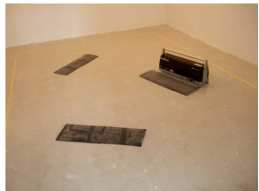
Fotografías 3 y 4. Colocación de las tres muestras sobre la losa de hormigón normalizada dentro del área de ensayo admisible.
